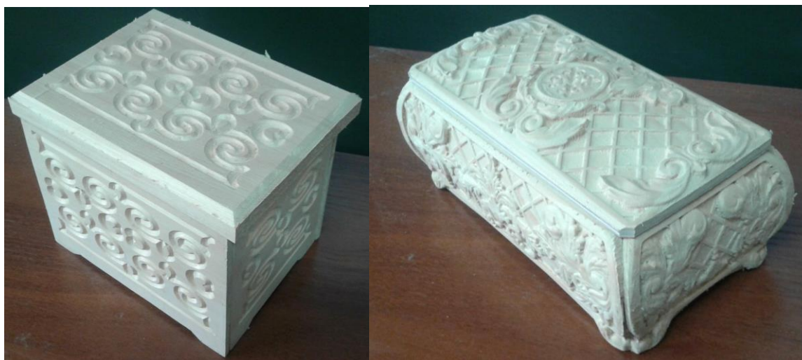
Шкатулки изготовлены на фрезерном станке с ЧПУ.
