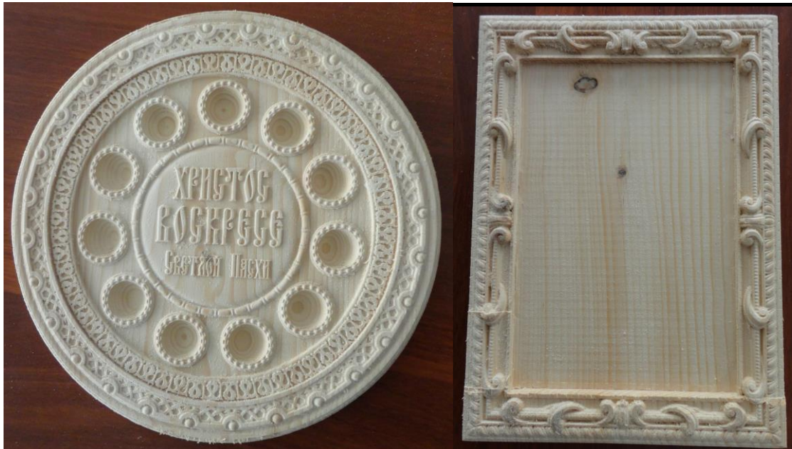
Изделия изготовлены на фрезерном станке с ЧПУ.
